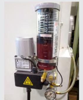
OPTIONNEL : SYSTÈME DE GRAISSAGE AUTOMATIQUE POUR LA TÊTE UNIVERSELLE.
